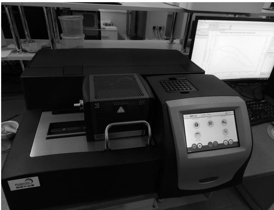
Рисунок 1 – Совмещенный термоанализатор – Discovery SDT 650
